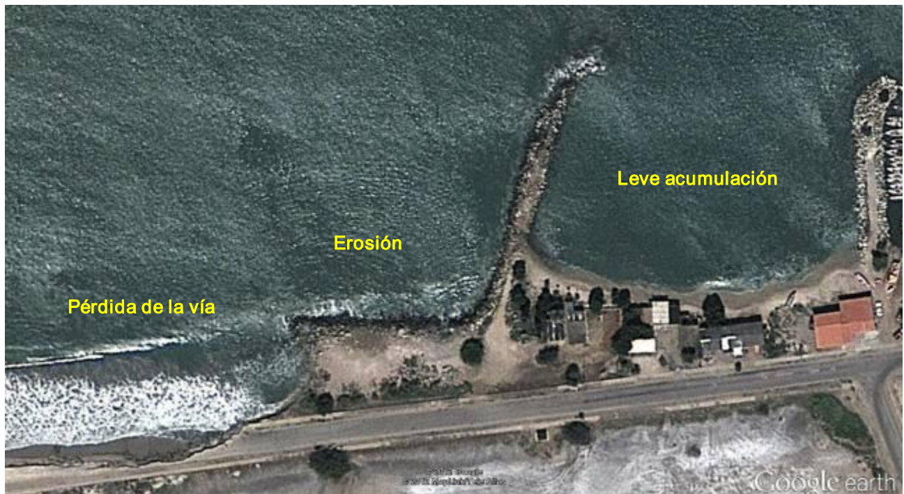
Figura 39. Espigones en La Guardia, Isla Margarita, imagen Google Earth.
