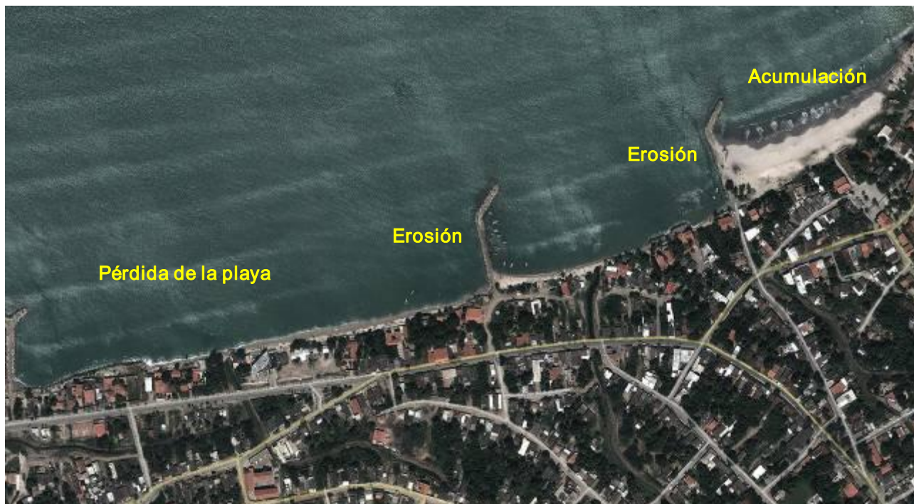
Figura 42. Campo de espigones en La Guardia, Isla Margarita, imagen Google Earth
