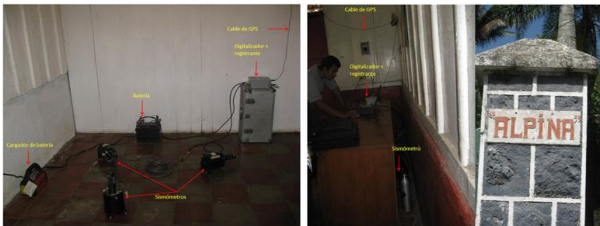
Figura 7. Equipo sísmico instalado en finca Santa Isabel (Izquierda) y finca Alpina (derecha) para el monitoreo de la actividad sísmica del volcán de San Miguel.
